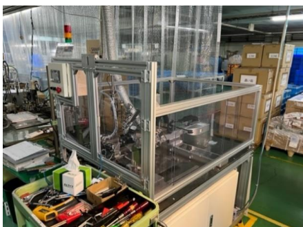
自動化プロジェクトの取り組みにより開発された「全自動巻線機」
