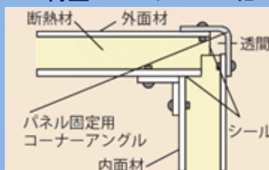
▲一般的な荷室フレーム断面
