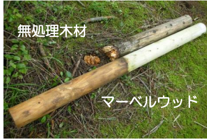
▲防腐・防蟻試験の様子
